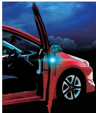
夜間、クルマでの走行時に、停車中のクルマのドアが開いているのが見えずに、ヒヤッとした事ありませんか? ドアの開閉に連動して点灯する「ドアウォーニングLEDランプ」は歩行者や自転車、後方から走ってくるクルマに、『今ドアが開いていますよ』とアピールできる安心・安全商品です。 ※ドア開放後、一定時間(約2分)経過すると消灯します。
